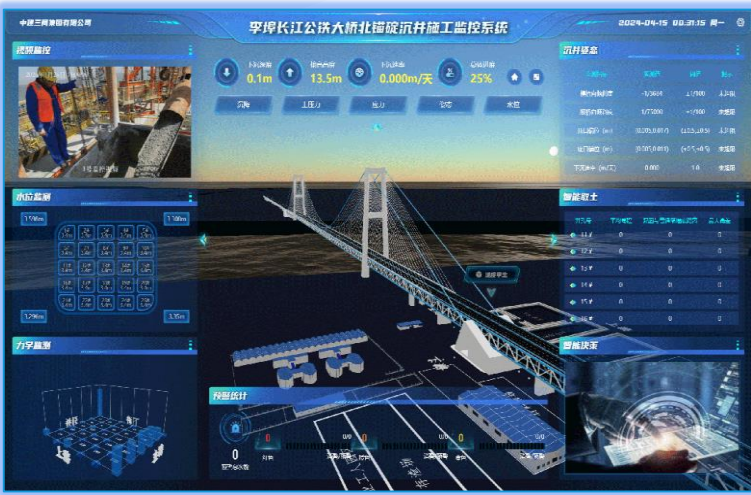
沉井数字化监控系统
